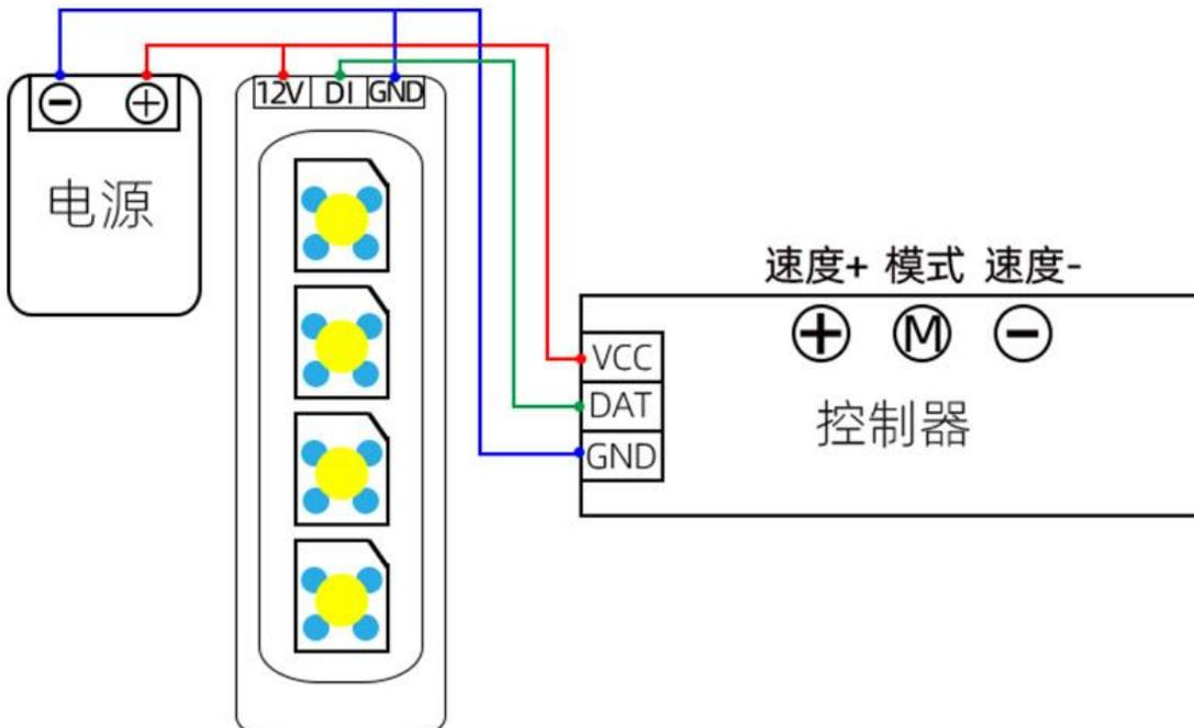
安装注意：1、先连接负载线，再接电源线；上电前确保连接线之间无短路现象；
